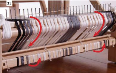
CHECK THE DIRECTION YOU ARE ROLLING THE WARP ON. IT MUST GO IN THE DIRECTION SHOWN BY THE ARROWS.
